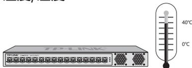
为保证光电一体配线架长期稳定工作，延长使用寿命，请维持环境一定的温度和湿度。过高或过低的环境湿度易引起绝缘材料漏电、变形甚至金属部件锈蚀现象，温度过高会加速绝缘材料的老化过程，严重影响设备使用寿命。该系列光电一体配线架的正常工作和存储温度/湿度如下表2-1。
